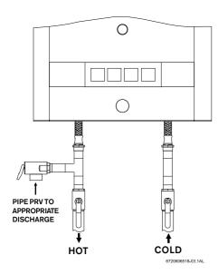
Fig. 7 - Pressure Relief Valve
