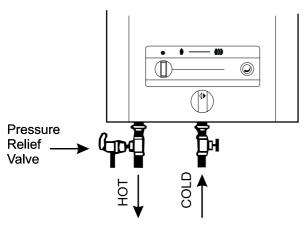
Fig. 4 - Pressure Relief Valve
